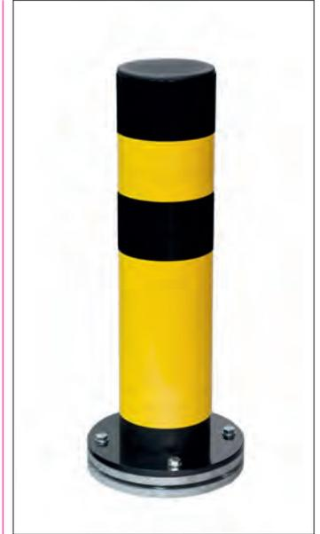
Variante del bolardo metálico flexible, que incorpora una base metálica giratoria equipada con 6 rodamientos rígidos de bola que soportan cargas radiales y axiales en ambos sentidos.
