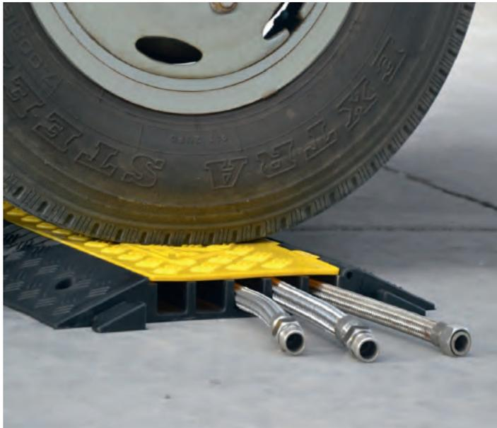
Canaleta pasacables para suelo, que permite el paso de cables, tubos y otros conductos. La mezcla usada de goma y caucho, proporciona una elevada resistencia a la abrasión y al paso de todo tipo de vehículos. Soporta un peso de hasta 8 t por eje.
