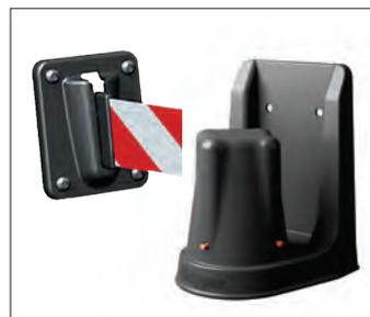
**Poste separador Dúmpper**, un pivote todoterreno que permite acoplar el cabezal con cinta para cono, de 95/130 mm Ø y altura 1.000 mm (1.110 mm con el cabezal acoplado) Muy estable incluso sobre suelos irregulares. Base rellenable de 500 mm Ø que aporta gran estabilidad. Incorpora elementos reflectantes.
