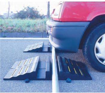
Rampa pasatubos que salvaguarda cables, tubos, mangueras y otros conductos de hasta 75 mm de diámetro, de ser dañados por el tránsito de vehículos. Fabricada en caucho reforzado, resistiendo eficazmente el paso de todo tipo de vehículos, pesados inclusive.
