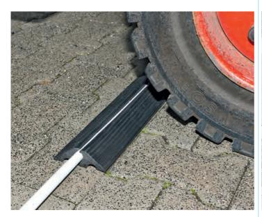
Cubrecables de goma para suelo con 1 canaleta que permite pasar cables, tubos, mangueras y otros conductos resguardándolos de las rodaduras de vehículos. La mezcla usada de goma natural y la combinación de soportes moldeados en la parte inferior, evita que se mueva y desplace incluso al paso de vehículos pesados.
