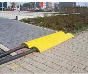
Badén pasacables para suelo con 3 canaletas fabricado en goma de caucho, que salva y protege cables, tubos y otros conductos del paso de vehículos en espacios interiores y al exterior. La mezcla usada de goma natural y la combinación de soportes moldeados en la parte inferior, permite aguantar el paso de carretillas elevadoras, camiones y demás vehículos pesados.
