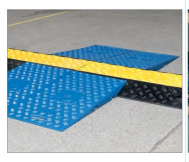
Rampa auxiliar fabricada en goma y caucho que complementa al sistema rampa pasacables de 3 y 5 canaletas. Consigue reducir el desnivel de la rampa pasacables para que peatones, carritos de bebés, sillas de ruedas, bicicletas, patines eléctricos, etc., puedan superarla sin peligro y que ello no suponga una barrera arquitectónica. Carga máxima de 200 kg
