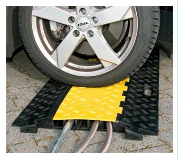
Rampa pasacables para suelo con 5 canaletas que protege cables, tubos o mangueras del paso de vehículos. Soporta un peso de hasta 8 t por eje. La mezcla usada de goma y caucho, proporciona una elevada resistencia a la abrasión y es adecuada para vehículos pesados.
