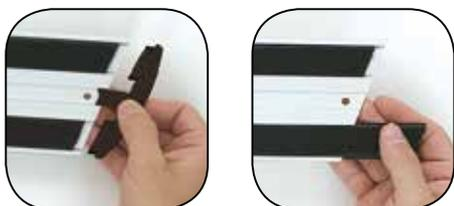
Acople seguro de las fundas. Los soportes de aluminio incorporan cintas extraíbles de velcro en la parte inferior para fijar las mopas. Las cintas se introducen en las ranuras y quedan fijadas con tapas extraíbles situadas en los extremos. Las cintas de velcro y las tapas para los extremos están disponibles como piezas de repuesto.
