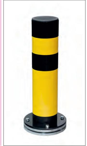
Variante del bolardo metálico flexible, que incorpora una base metálica giratoria equipada con 6 rodamientos rígidos de bola que soportan cargas radiales y axiales en ambos sentidos. El resultado es un bolardo flexible capaz de amortiguar un choque frontal y lateral, inclinándose a la vez que gira sobre su propio eje.
